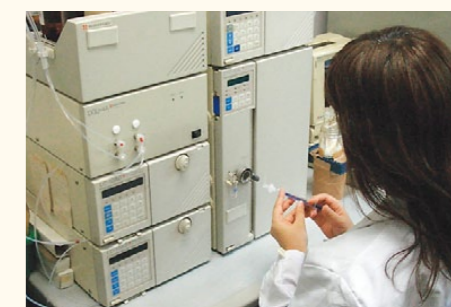
油入変圧器の絶縁劣化診断
