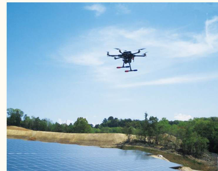
▲マルチコプターによる太陽光パネルの点検
