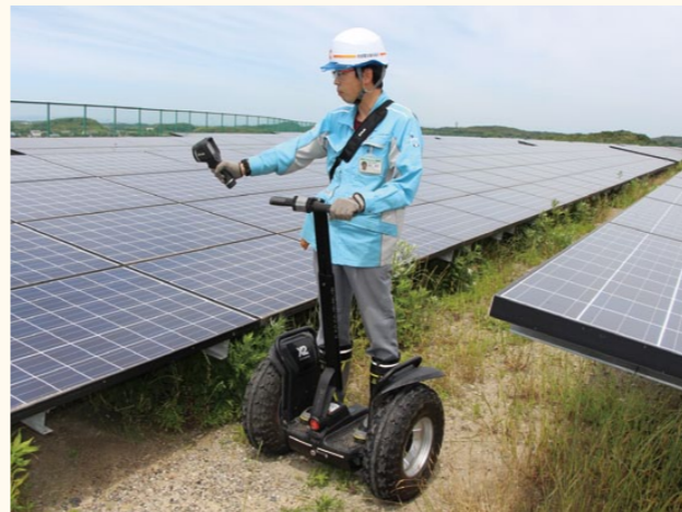
▲セグウェイを利用した赤外線熱画像カメラによる太陽光パネルの点検
