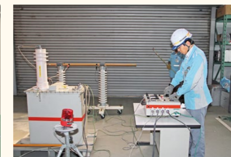
絶縁保護具類の耐電圧試験
