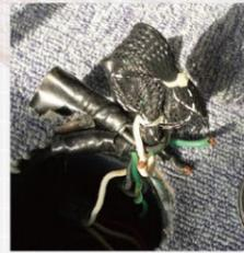
写真② 配線が断線していたフロアコンセント
