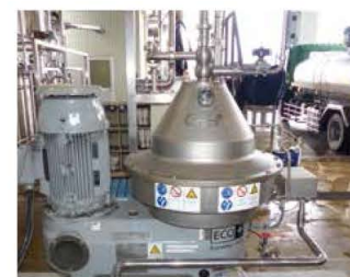
除菌セパレーターで品質を向上
