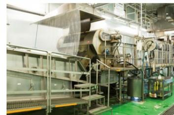
吸水した白米を清浄な蒸気で蒸すことのできる多段式連続蒸米機
