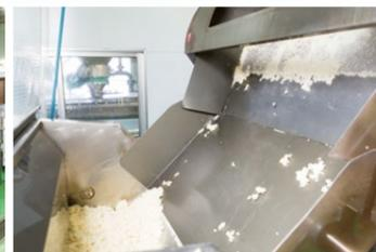
蒸米をそれぞれの用途に合わせた温度まで冷却する蒸米放冷機
