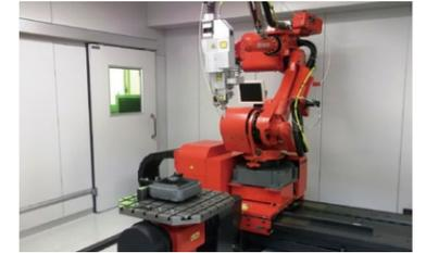
レーザー溶接ロボット(4kW)
