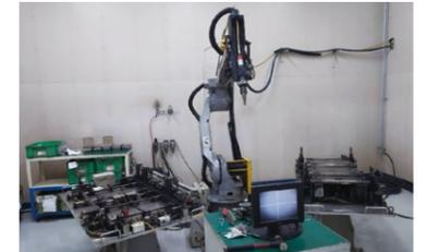
レーザー溶接ロボット(2kW)
