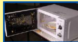
電子レンジで温めたゆで卵が破裂した様子
