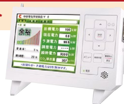
電力デマンド監視装置
